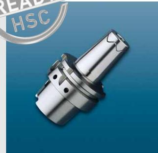
Das Power Shrink Chuck ist das Schrumpffutter für höchste Zerspanleistung bei der Hochgeschwindigkeitsbearbeitung. Das optimierte Design mit verbesserter Bauweise verbindet hohe Steifigkeit mit Schwingungsdämpfung. Das schont Maschine, Spindel und Werkzeug. Die langen Ausführungen (A = 130 und 160) mit schlanker Spitze sind besonders universell einsetzbar.
