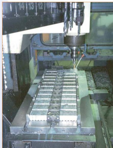
Пример эффективного размещения обрабатываемых изделий на поверхности горизонтального рабочего стола станка ЧПУ (Т-образный паз), при использовании прижимов OK-VISE.
